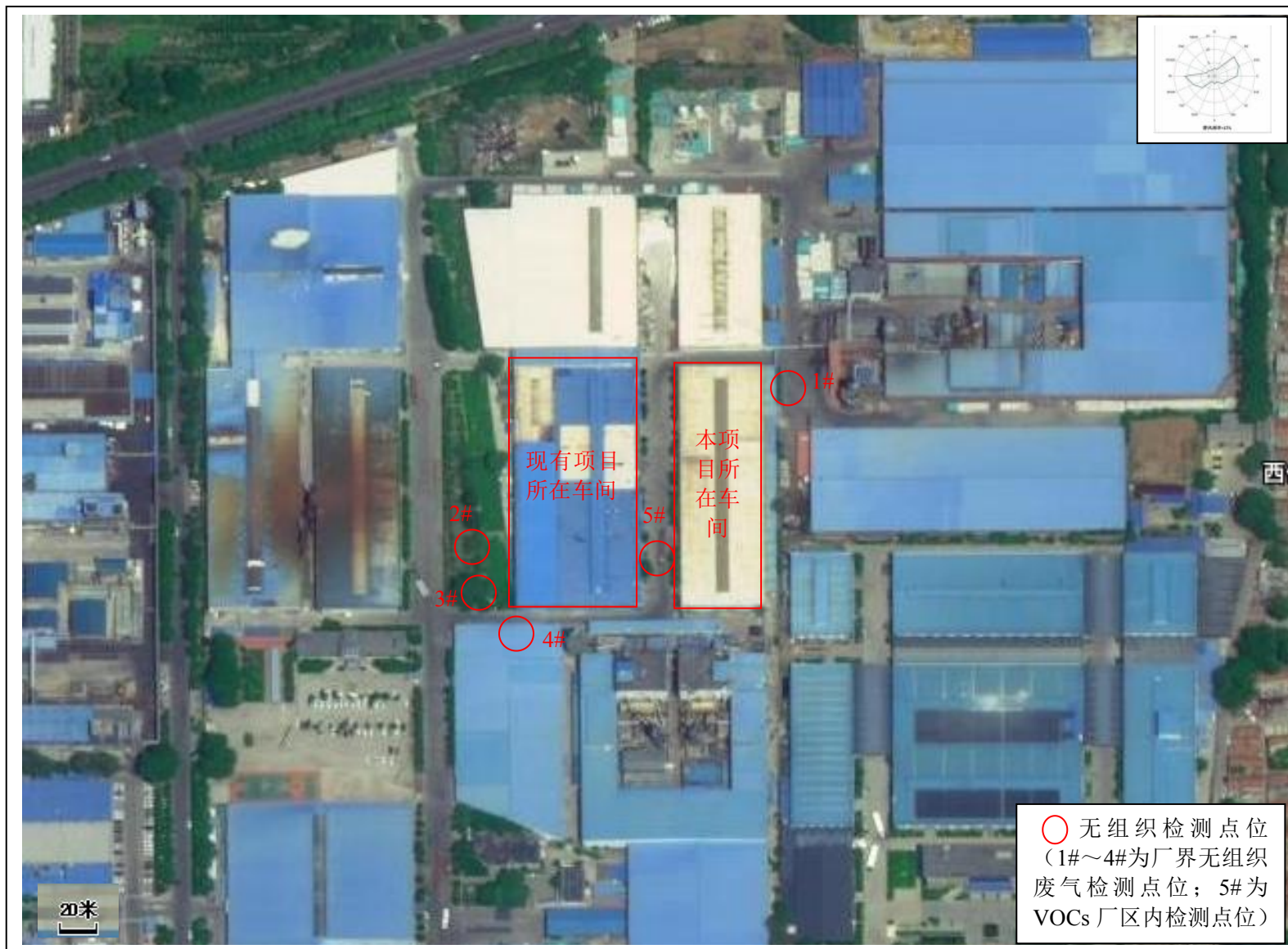
附图 6 无组织检测布点图（本图设点以当地主导风向为参考，实际检测以当日风向为准）
