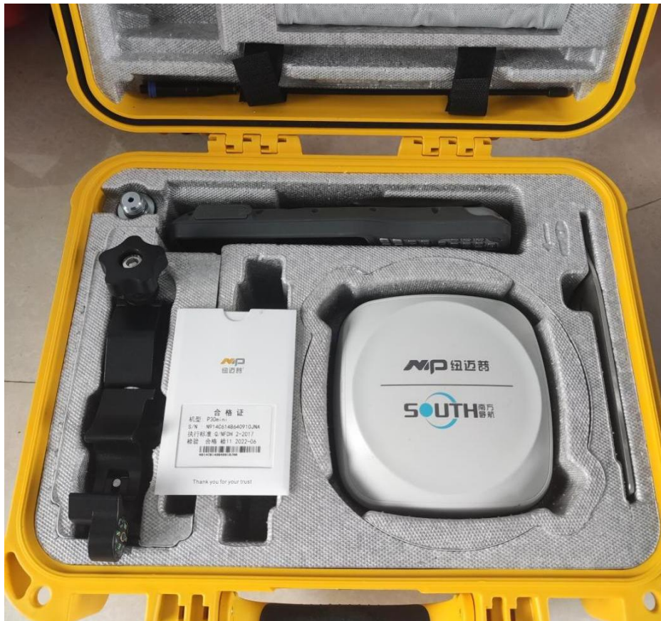
照片 1.2 南方科技 GPS 接收机 (P30)
