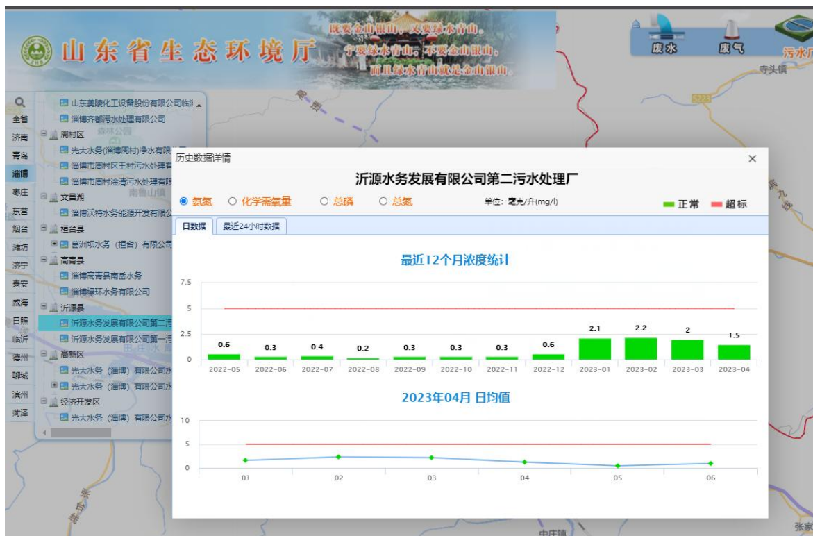
图 5.2-1 (2) 污水处理厂近一年氨氮自动监测数据
