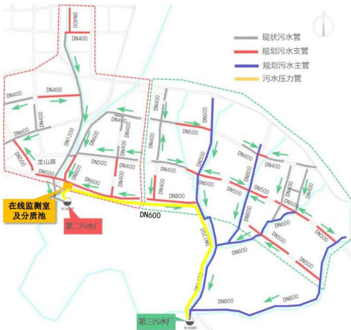
图 2.5-2 本项目规划管网铺设图
