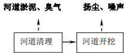
图2-1 河道清淤扩工程工艺流程及产污环节图
