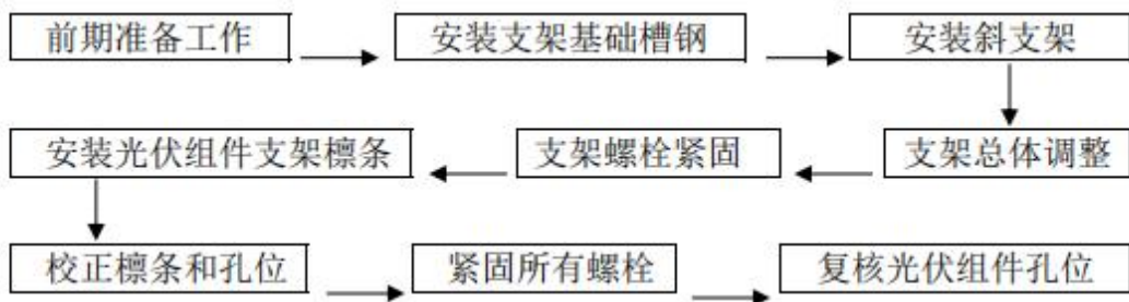
图 2-2 光伏组件安装流程
